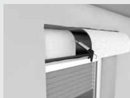
**5** Inserire la preforma della calotta di copertura tagliata lungo il cassonetto dell'avvolgibile.
